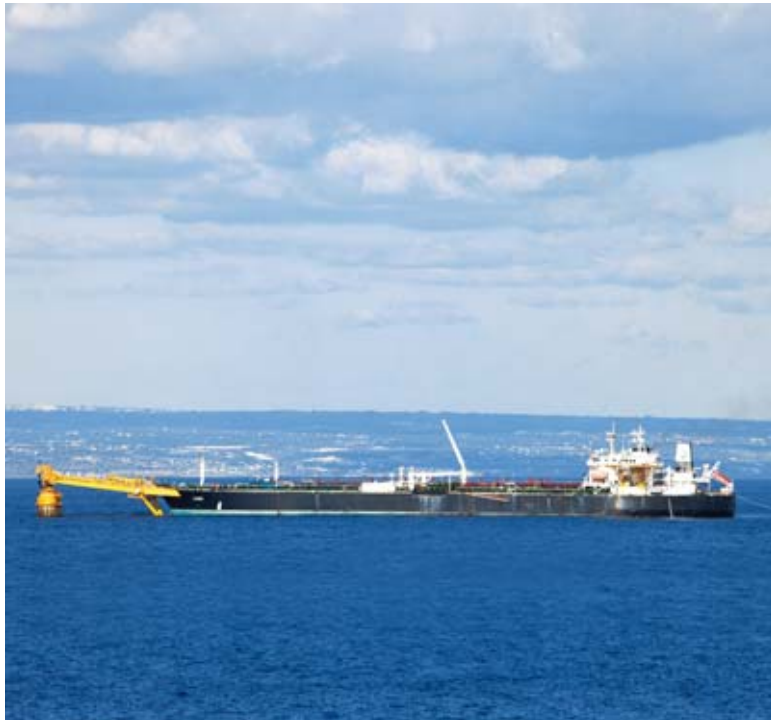
Inaugurata la Floating Storage and Offloading (FSO) Leonis grazie alla quale è ripresa l'attività del Campo Petrolifero Vega, collegato alla nave serbatoio attraverso tre condotte sottomarine.
